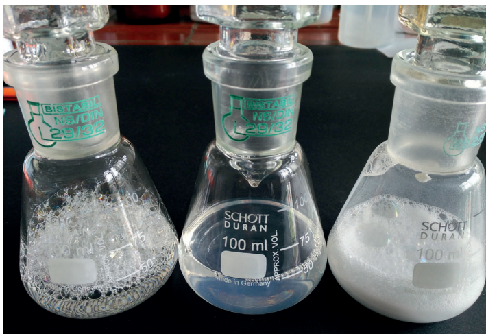
Eine Mikroemulsion (Mitte) eignet sich, um Mikroplastik zu markieren; zum Vergleich: links ein Tensidsystem, rechts eine makroskopische Emulsion.
