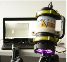
Hygiene-Monitor zur Überwachung von Oberflächen für die Lebensmittelproduktion und Medizin
